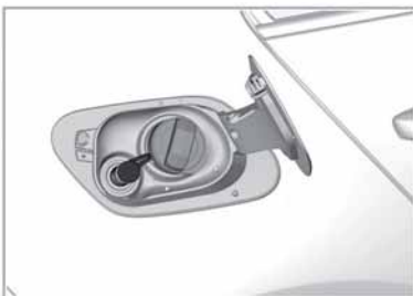
Gaseinfüllstutzen mit Rückschlagventil
