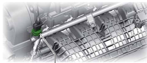
Temperatur- und Drucksensor für Gasverteilerleiste GX21
